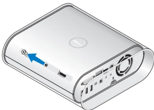
2. Platzieren Sie den Computer vertikal und ziehen Sie die Schutzhülle vorsichtig in Richtung der Rückseite des Computers. Schieben Sie anschließend die neue Schutzhülle vorsichtig über den Computer.
